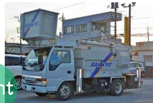
電柱建設の専門車両
