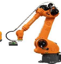
ピッキングロボット
